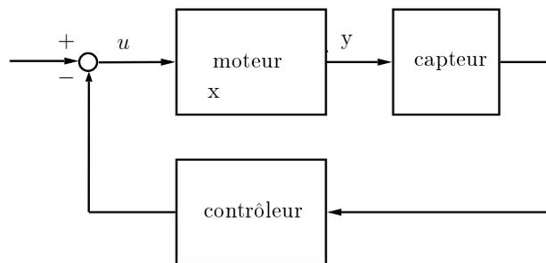
Le capteur délivre la mesure avec retard  $\text{sgn}(\text{carburant/air} - 1)$ . L'information est instantanément transmise au contrôleur, qui fournira les modifications à apporter au mélange carburant /air.
