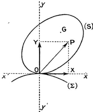
Étant données, à l'instant  $t_0$  où commence le choc, les composantes  $\alpha_0, \beta_0$  de la vitesse du point G et la rotation instantanée  $\omega_0$  de la plaque, il s'agit de déterminer, à l'instant  $t_1$  où le choc se termine, les quantités analogues  $\alpha_1, \beta_1, \omega_1$ .
