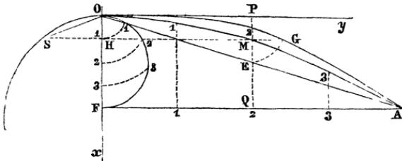
*cercle, en S, perpendiculairement à Ox, un point M quelconque de la parabole, la distance MH du point M à l'axe et la corde OS sont dans un rapport constant.*
