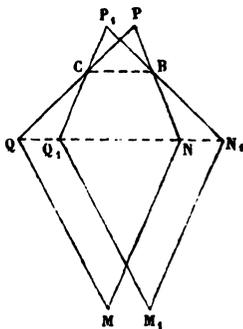
Alors, si l'on fixe  $M_1N_1$ , et que l'on supprime les tiges inutiles MN, MQ, le point N décrit une droite perpendiculaire à  $M_1N_1$ , et l'on obtient le premier appareil à ligne droite, composé de cinq tiges, de M. Hart. Mais, si l'on conserve les deux tiges MN, MQ, on réalise, au moyen de sept tiges seulement, le mouvement de la droite MN parallèlement à elle-même. On a vu, dans notre article antérieur, que la seconde disposition de M. Hart permet d'obtenir le même résultat.
